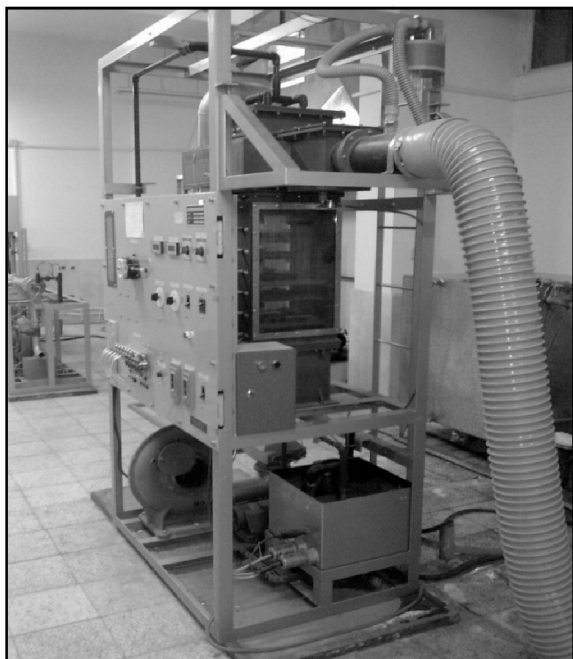
شکل (۱): برج خنک کن مورد آزمایش
