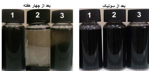
شکل ۷- بررسی میزان پایداری نانو سیال پایه اتیلن گلیکول گرافن ساخته شده با عامل فعال سطحی ۱-CTAB ۲-تری‌تون-۱۰۰-۳-صمغ عربی
