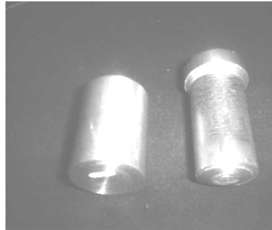
شکل (۹): Billet و قطعه‌ی تغییر شکل یافته نهایی [۱۱]
