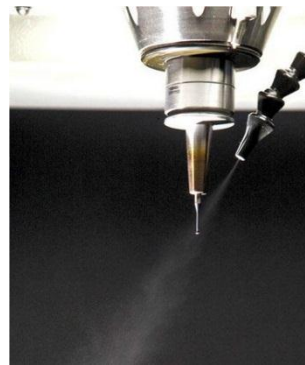
شکل (۲): استفاده از روش حداقل مقدار روانکاری و غبار روغن ایجاد شده در اطراف ابزار [۱۱]
