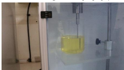
شکل (۷): دستگاه فراصوت با هورن خارجی [۲۳]
